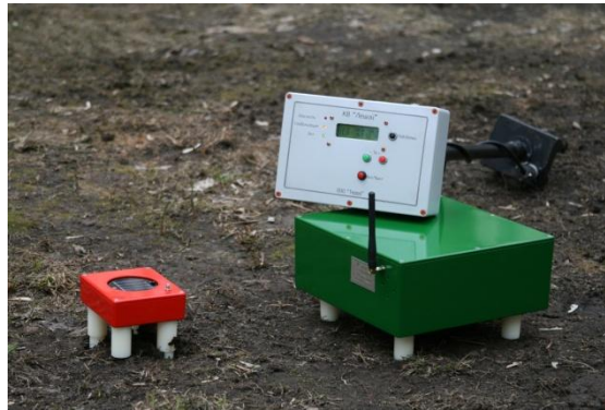
Слева – стационарный вариант с солнечной батареей, справа – стационарный вариант без солнечной батареи, сверху – мобильный вариант для патрулей и обходчиков
