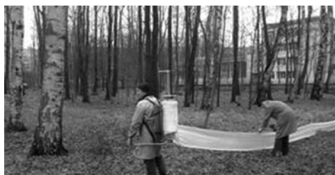
Рис. Противопожарный экран нижней границей экрана с помощью ранцевого опрыс-из кремнезёмной ткани кивателя.
